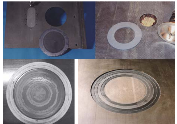
Figure 5: Détourage, scarfing et stepping
